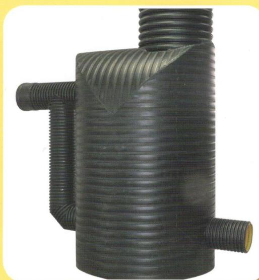
منهول های پلی اتیلن شرکت نشاگستر پردیس در اقطار و ابعاد مختلف قابل طراحی و ساخت می باشد، این منهول ها با دستگاه های پیشرفتہ در اشکال مورد نظر برش خورده و با جوش اکستروژن مطابق با استاندارد DVS 2207 و DVS 2203 جوشکاری می شود.
